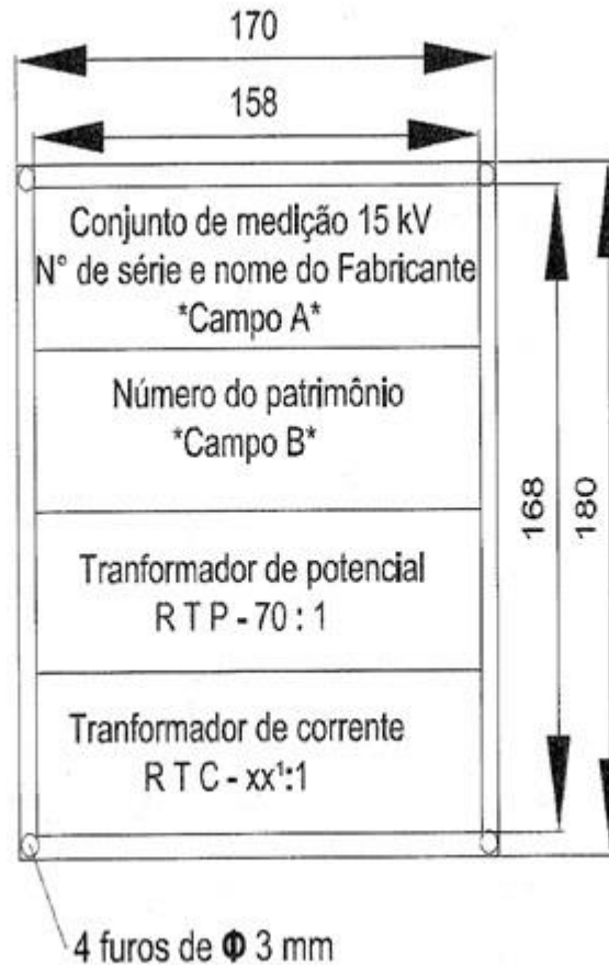
Figura 2: Placa de Identificação instalada na tampa da caixa na parte interna
